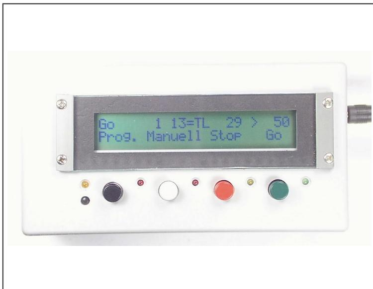
Diese Foto-Auslöse-Steuerung ermöglicht das Auslösen eines Fotoapparates, sowie Start von Fokus und Blitzlicht nach Ablauf eines Timers oder Erreichen einer Zeit und / oder dem Eintreffen eines Ereignisses.
